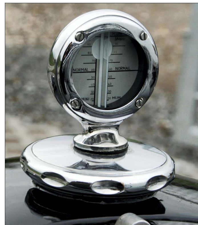
Das Instrument zum Anzeigen der Temperatur des Kühlwassers ist auf der Motorhaube des Wagens angebracht. Foto: Fabian Klaus
